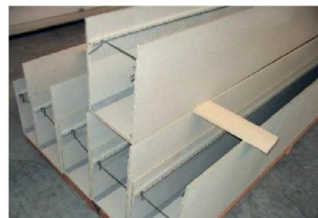
Ove prešane ploče od drva i cementa se tijekom proizvodnje pomoću Multi-jakog ljepila lijepe pod kutom od 90° u U-profile i L-profile zajedno s trokutastom PVC-letvicom koja služi za stabilizaciju.
