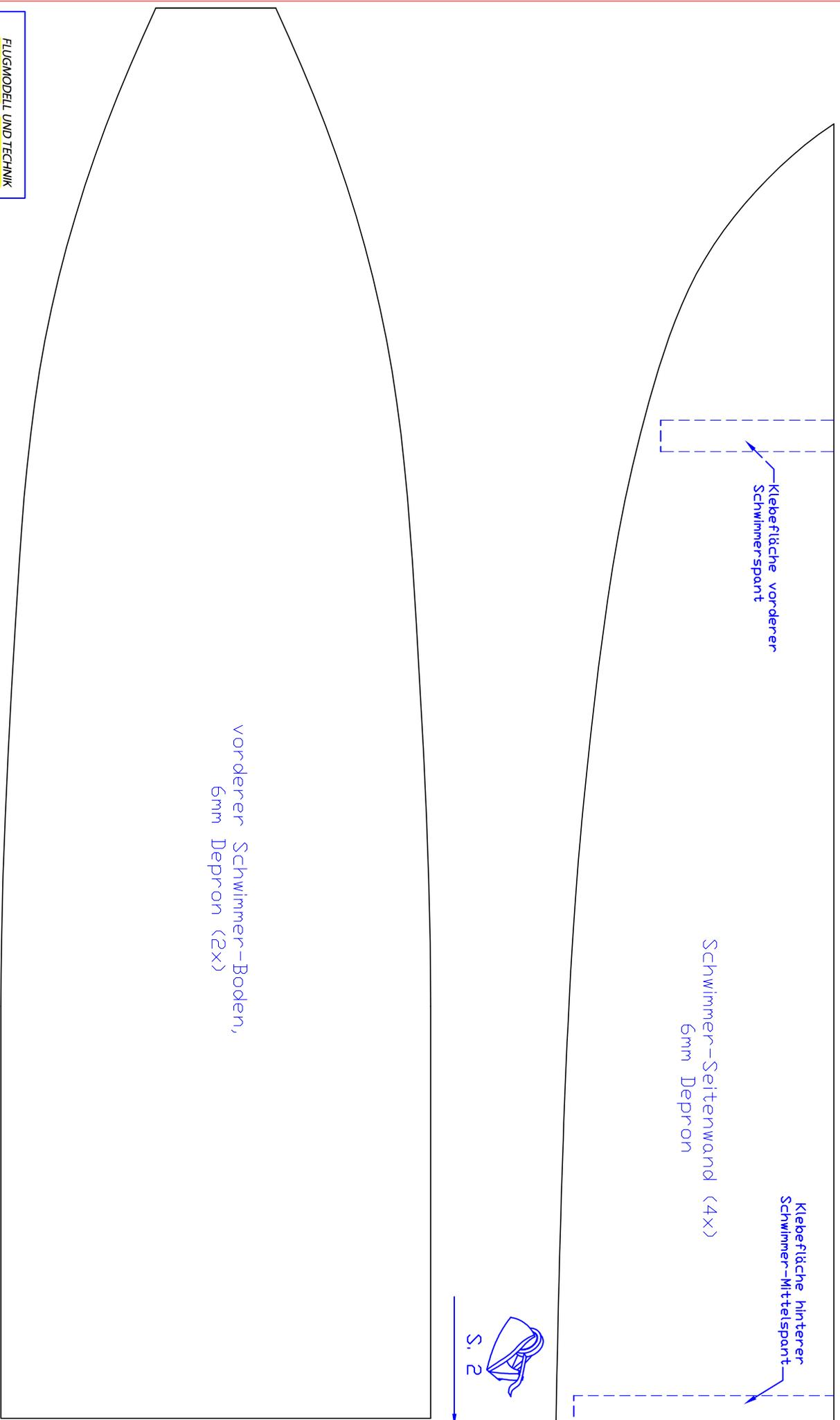
Klebefläche hinterer Schwimmer-Mittelspant
